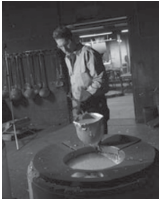
(ဈ) မိုက်ခရိုဝေ့(ဖ်)သုံးသတ္တုရည်ကျိုမီးဖို
